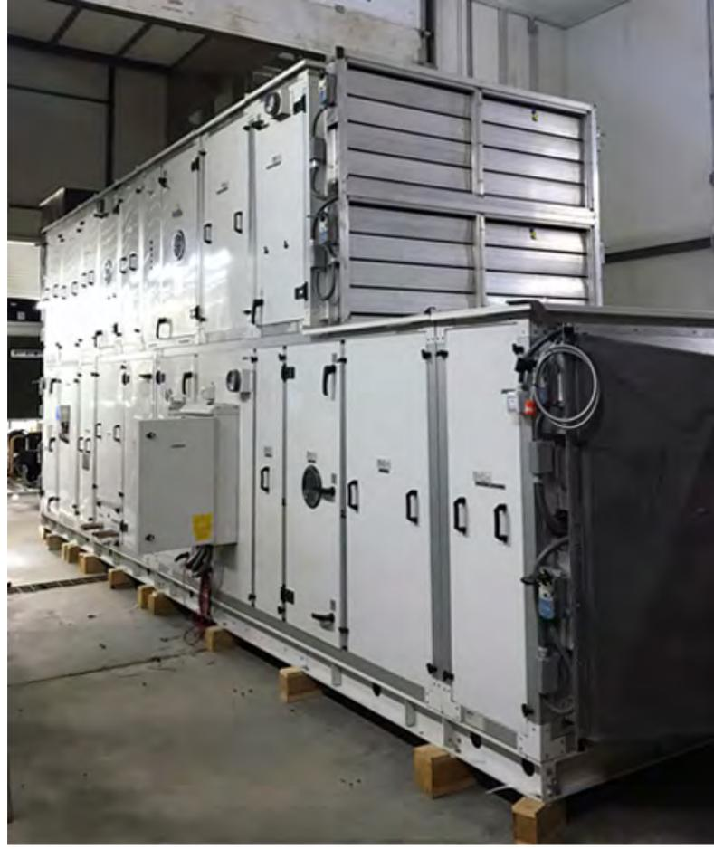
طوّرت شركة الزامل للمكيفات المركزية مؤخراً وحدات مناولة الهواء مزدوجة الجدران، ووحدات تكييف مُبردة بالهواء مزدوجة الجدران، بمواصفات خاصة، حيث صُمّمت خصيصاً لتلبية متطلبات مشروع "قطار الرياض" من أجهزة وحلول تكييف الهواء. وتوفر هذه الأنظمة المتخصصة أقصى قدر من المرونة لهذا المشروع الوطني الرائد، إلى جانب الكفاءة العالية في استهلاك الطاقة.
